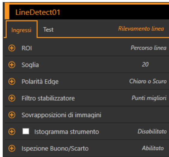
Figura 180. Strumento Line Detect - parametri di ingresso
