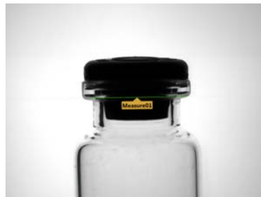
Figura 216. Strumento Measure da Edge02 a Edge03
