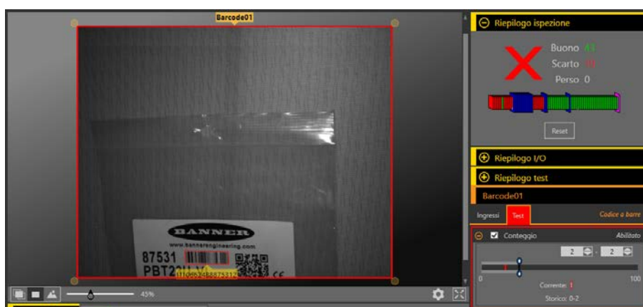
Figura 281. Pezzo da scartare: lettura di un solo codice a barre
