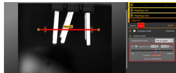
Figura 263. Pezzo da scartare: pin piegato
